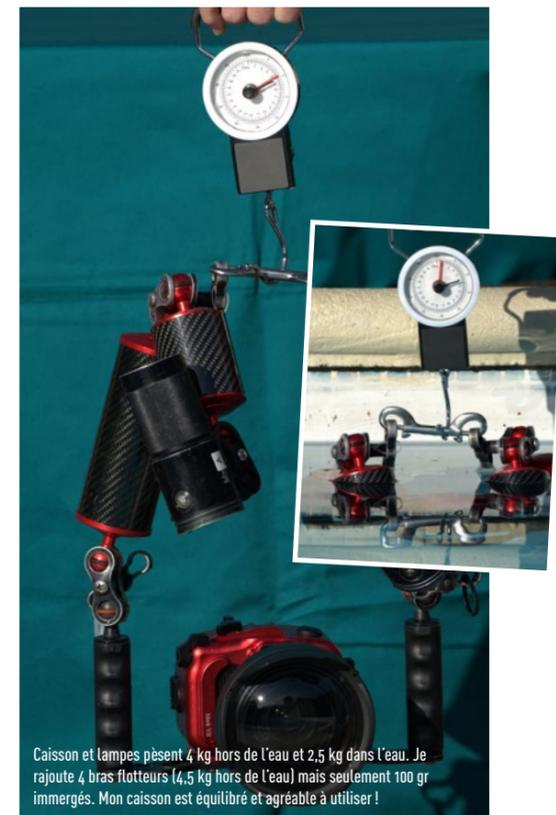
Caisson et lampes pèsent 4 kg hors de l'eau et 2,5 kg dans l'eau. Je rajoute 4 bras flotteurs (4,5 kg hors de l'eau) mais seulement 100 gr immergés. Mon caisson est équilibré et agréable à utiliser!
